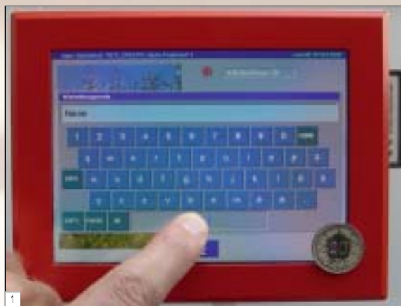
Bild 1: Das eigerPanel 57 bietet einen kompakten Embedded-Computer mit LED-Hintergrundbeleuchtung.
